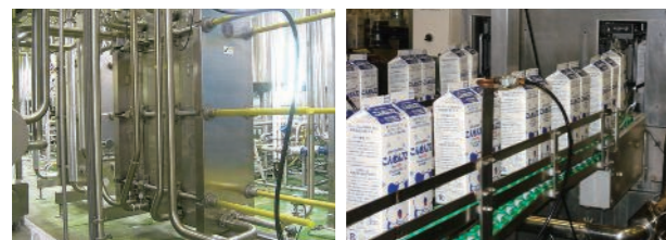
(左)HTST 殺菌機、(右)工場でのパック詰めの様子
