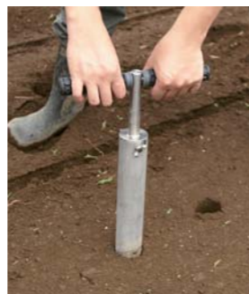
土壌はサンプルを採取し、精密測定のできるゲルマニウム半導体検出器などで測定。
