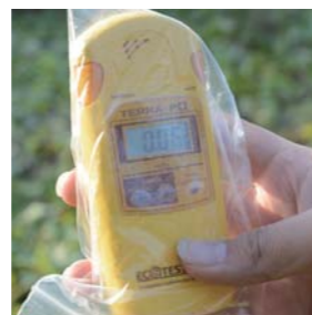
関東近郊の産地では、ガイガーカウンターを使って空間線量を把握。
